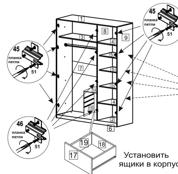
**Внимание:** Если вам необходимо стянуть между собой рядом стоящие шкафы, то на боковинах [9] нужно досверлить отверстия сверлом d=5мм, и стянуть рядом стоящие боковины стяжкой 52. При этом на боковину идет по две стяжки, поэтому перед засверловкой необходимо определиться с уровнем высоты, на котором будет производиться стягивание, и досверлить.
