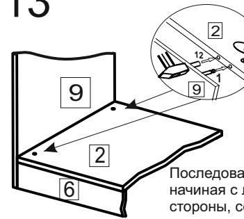
Последовательно, начиная с левой стороны, соединять детали корпуса стягивая между собой установленной фурнитурой.
