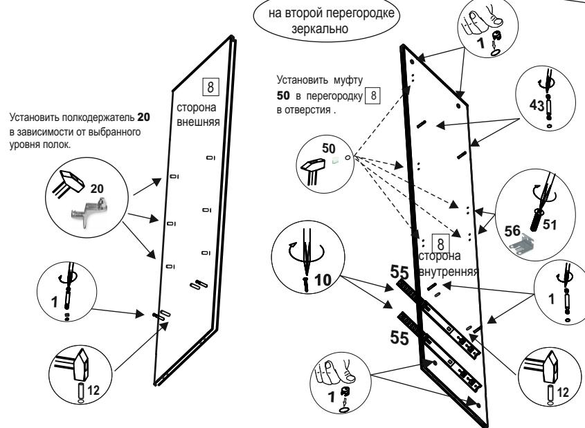
**Внимание:** на перегородках 8 под направляющие нанесены дублирующие отверстия, которые являются ориентиром центрального расположения направляющих по высоте и могут не совпадать с отверстиями на самой направляющей. Направляющие установить в плотную к краю перегородки 8 и зафиксировать.
