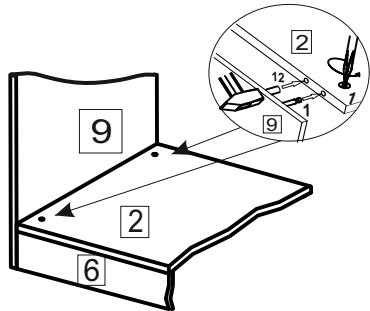
Последовательно, начиная с левой стороны, соединять детали корпуса стягивая между собой установленной фурнитурой.
