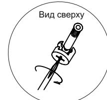
**Схема соединения болта с эксцентриком**
